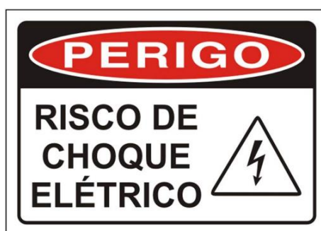
Figura 6 - Placa de advertência a ser fixada na parte externa do painel.
