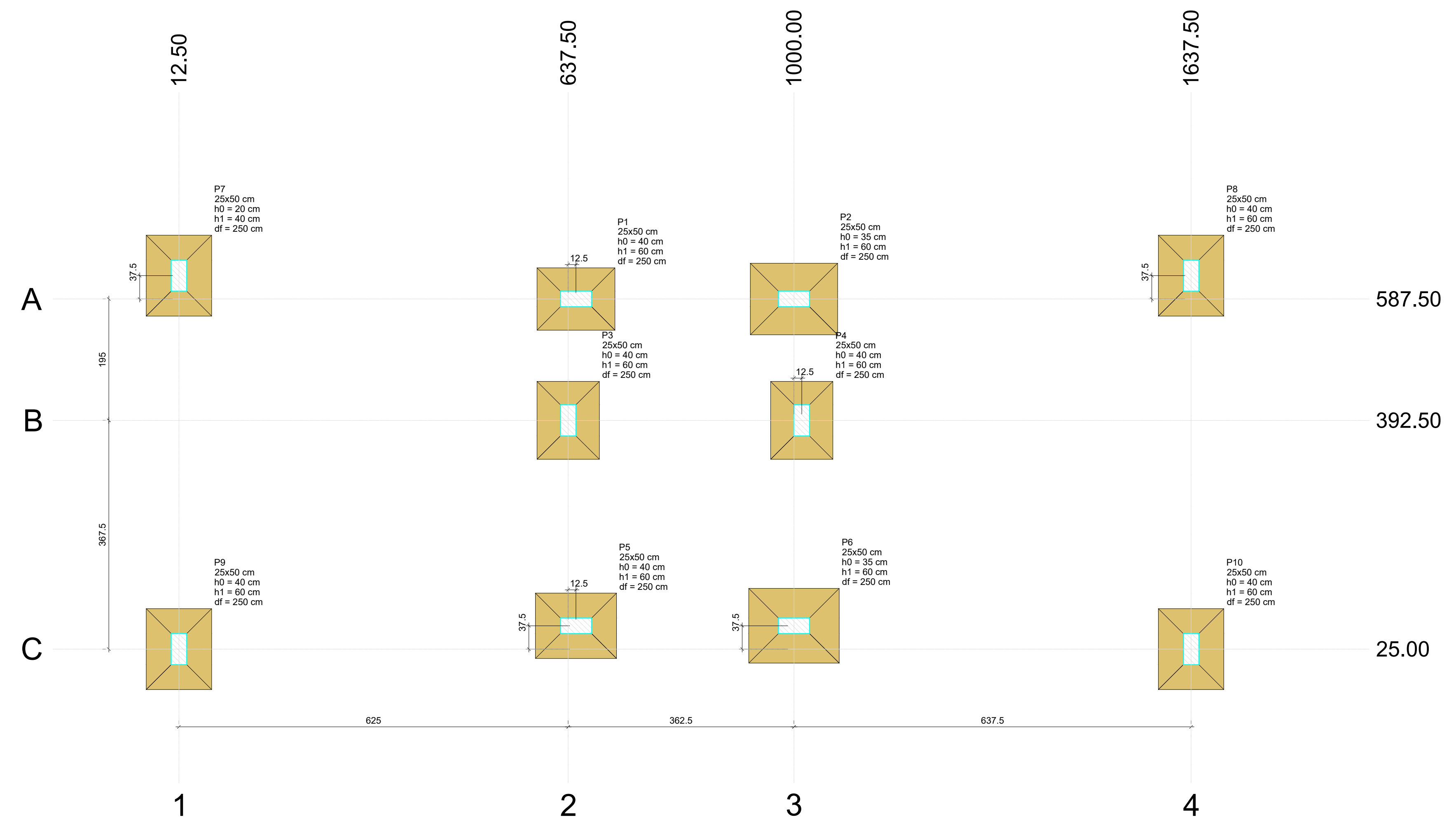
PLANTA DE LOCAÇÃO Escala 1:50
